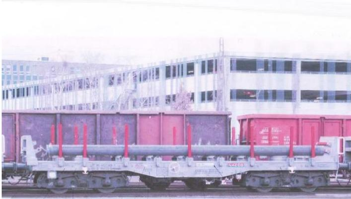
Der Wagen ist mit fester Ladeschwelle ausgerüstet, wobei man nur doppelte Stützwände als Verstärkung verwendet für die festen Stirnseiten. Dieser Wagen steht als Vorbild für den Zusammenbau.
