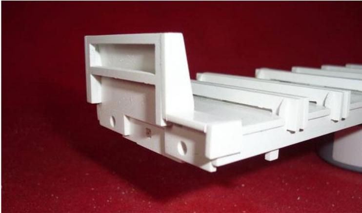
In Drehpunktbereich wird eine Verstärkung geklebt für die Zapfen.
