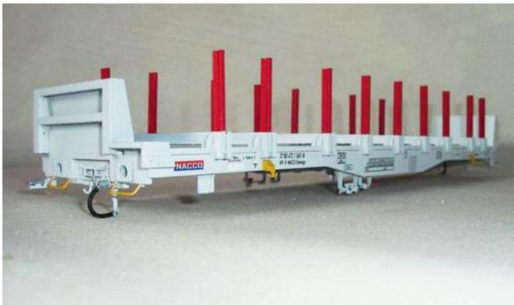
Die Entlüftung Gestänge werden aus Draht von 0.6 mm angefertigt, worüber 2 Splinte als Gestänge Halter geschoben sind.
