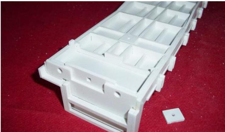
Die Rungen sind H Profilen (4 x 4 mm) die zwischen die gedoppelten Ladeschwellen geklebt werden.
